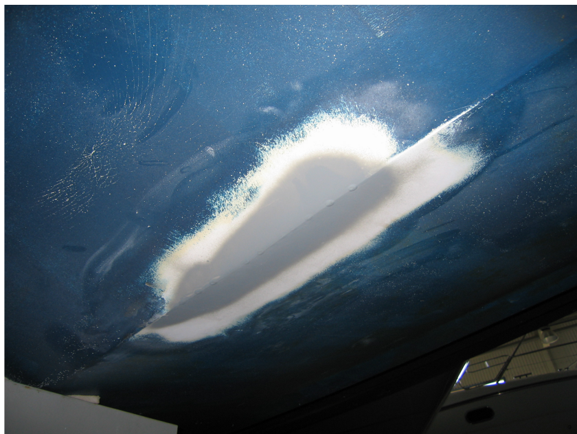
Рис. 11. Реставрированный скол продольного редана катера Sunseeker 44 Camarque
