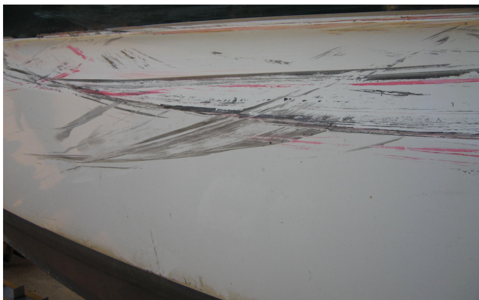
Рис. 16. Зона контакта при аварийном столкновении при отсутствии нарушений непроницаемости.
