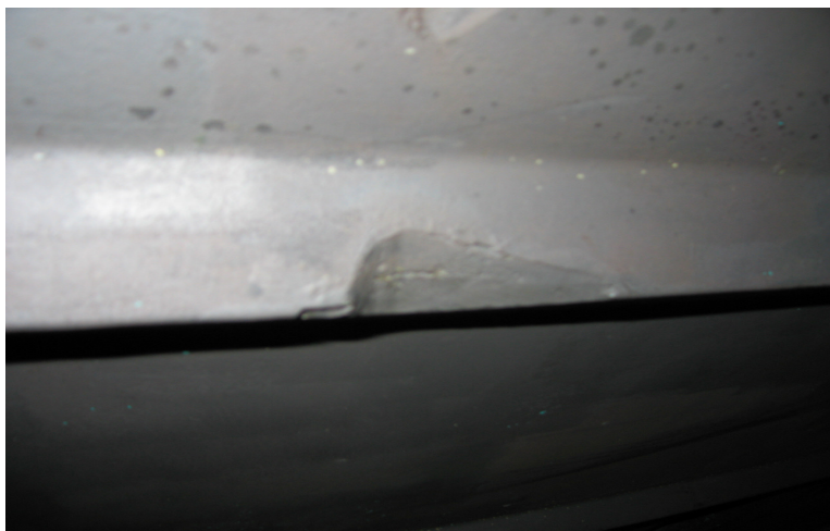
Рис. 9. Скол продольного редана катера Azimut 42
