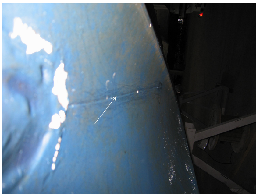
Рис. 12. Трещина в районе mortar гребного вала катера Sunseeker 44 Camarque
