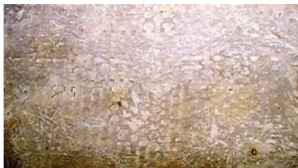
Рис.3. Клетчатый рисунок представляет собой непроклей стеклоткани на крупном катере для спортивной рыбалки.
