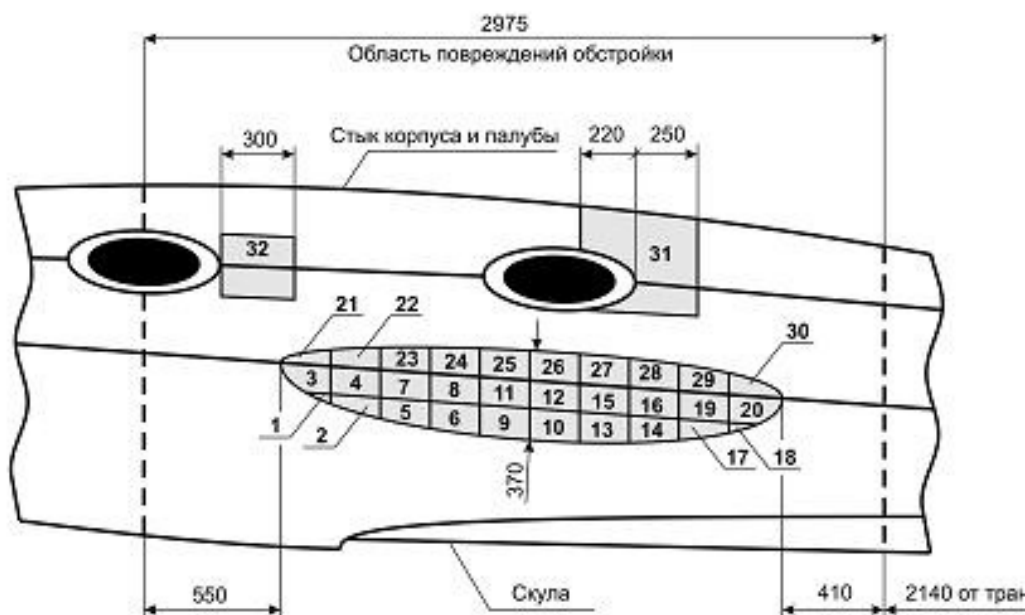
Рис. 17. Зона расслоений вокруг пятна контакта при аварийном столкновении при отсутствии нарушений непроницаемости.
