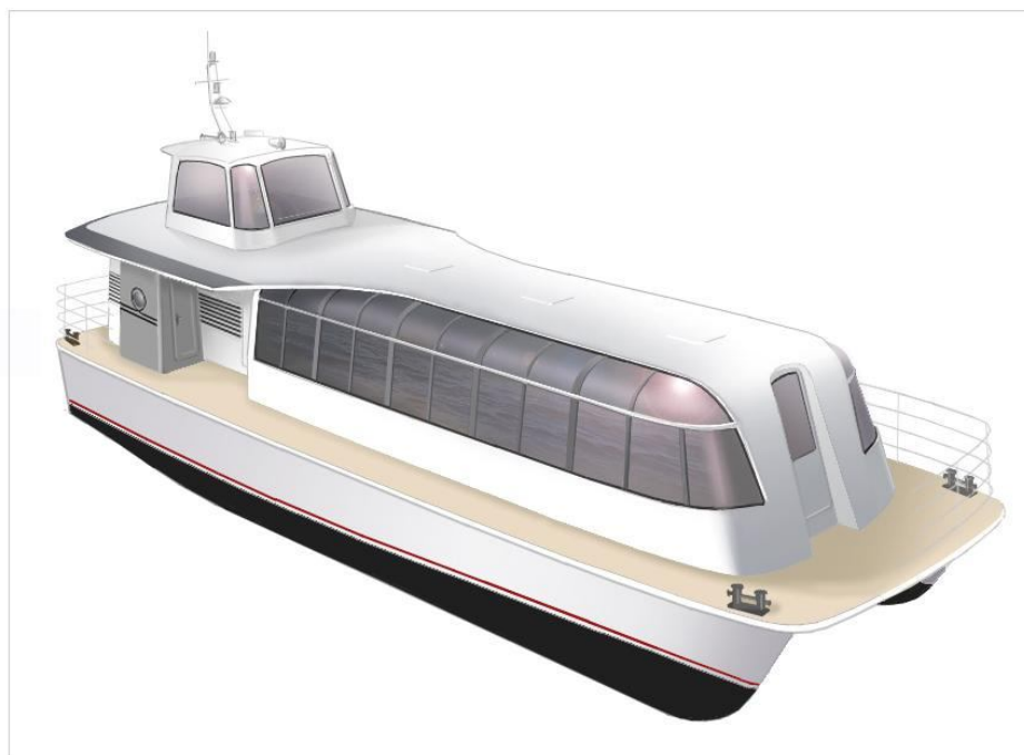
Рис. 9. Перспективный тип скоростного катамарана с надстройкой многослойной оболочковой металлополимерной конструкции. Общий вид.
