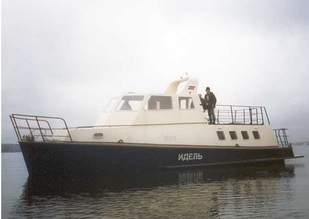
Рис. 7. Катер пр. 82340 с надстройкой многослойной оболочковой конструкции. Внешний вид.
